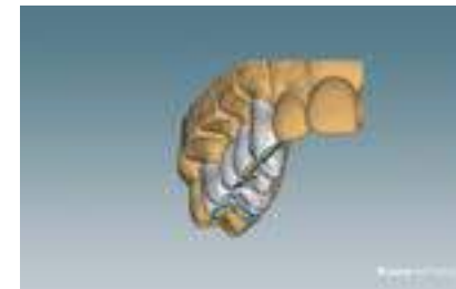
CAD yazılımı antagonist çene modeline göre pozisyonlayarak kontak ve penetrasyon alanlarını renk haritası ile işaretler.
